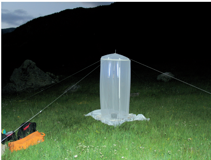
Fig. 4 Les torres de llum han estat un sistema d'atracció d'heteròcers especialment utilitzat per lepidopteròlegs de l'Europa Central que darrerament s'està provant a casa nostra. Consisteix en un cilindre de tul a l'interior del qual s'installa alguna font de llum; en el cas de la figura, dos fluorescents de llum actínica de 15 W. Les papallones són atretes de totes les direccions i es posen sobre les parets del parany, on són observades. És un sistema d'atracció que requereix la presència permanent de l'observador.
